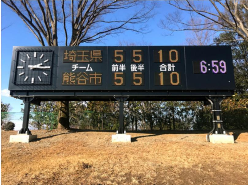
老朽化した既設のパネル式スコアボードを撤去し、新たにLED式スコアボードが設置されました。チーム名や得点は直感的で使いやすいセイコー独自の専用ソフトウェアを用いた得点入力装置（ノートPC）から入力できます。また、ゲームタイム操作盤ではゲームタイム、インターバルタイムなどの設定や操作が可能です。グラウンドの近くに設置されているため、塔時計には防球ガードが付いています。
