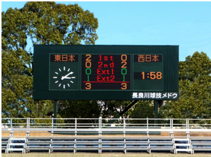
老朽化した既設のパネル式スコアボードに代わり、新たにLED式スコアボードが設置されました。サッカー、ラグビー用のチーム名、得点表示に加え、アメリカンフットボールのクォーターごとの得点表示やタイムアウトの回数表示、更にテキストメッセージの表示もできるようになりました。得点入力や試合時間の操作はノート型PCのスコアボード入力装置で制御可能です。
