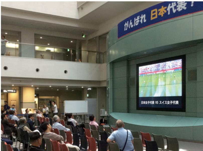
地下2階「区民ひろば」に設置されたマルチディスプレイは、46インチのディスプレイ12面（横4面×縦3面）で構成された約150インチの大画面です。通常時は区からのお知らせなどが表示されていますが、テレビ放映によるパブリックビューイングも可能です。
