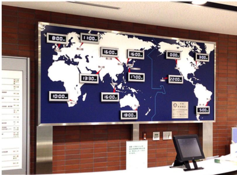
【外形寸法】 W2,800×H1,250mm LED式
