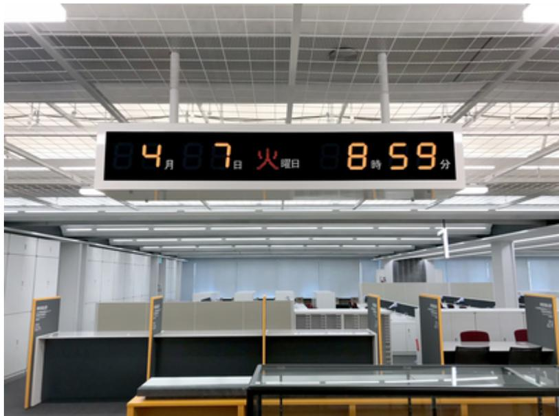
【外形寸法】 W1,600×H300×D300mm (両面吊下型)
