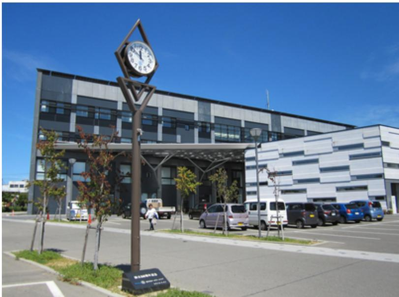
φ700（両面） ソーラー式 鋼板製
