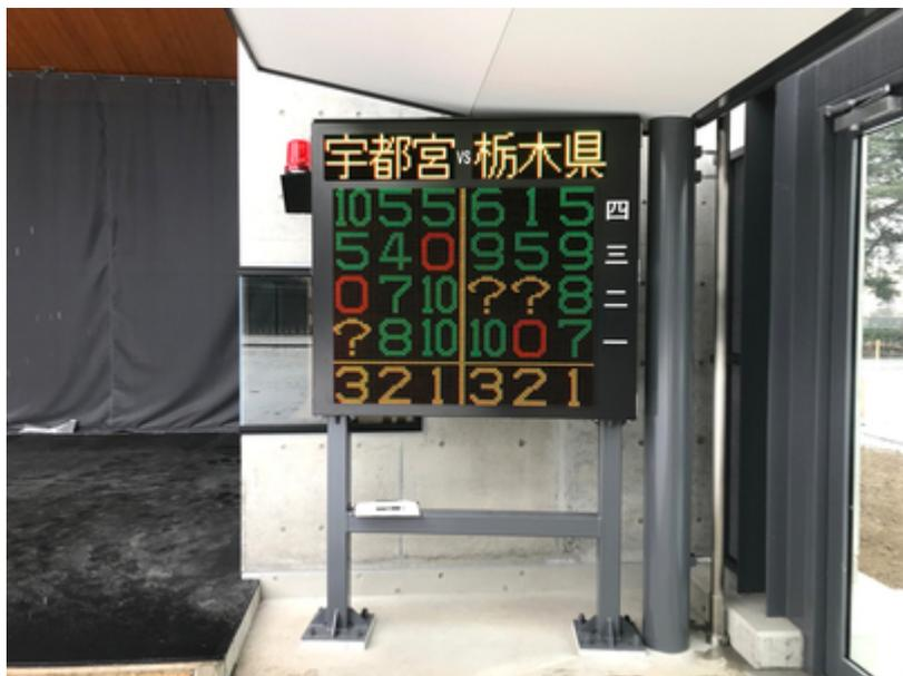
弓道の遠的競技（6人立ち）に対応。看的所に設置された的中点操作盤での中および得点結果を入力することにより、的場に設置されたLED表示盤および射場のモニターに結果を表示します。赤色回転灯とブザー音の鳴動による警告で矢取り時の安全性を確保します。
