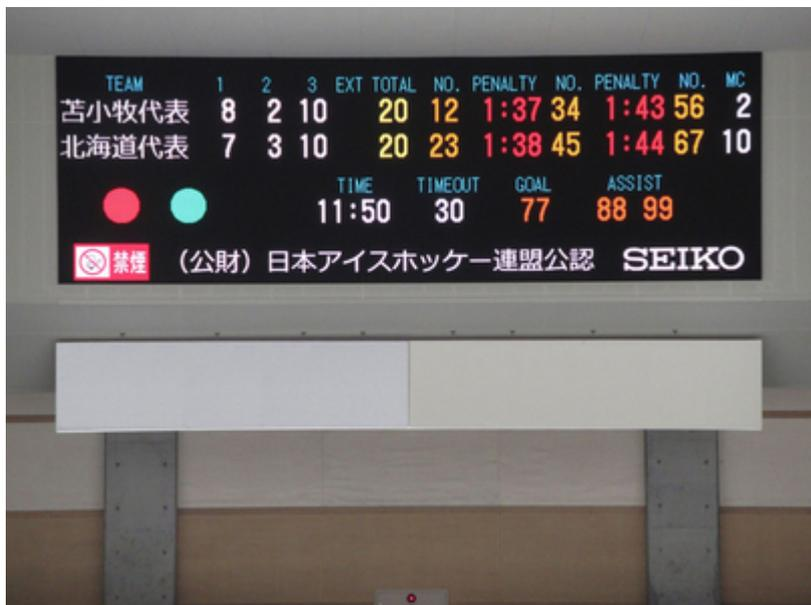
開業以来、20年以上使用していた既設の電球式表示盤をフルカラーLED式に更新。アイスホッケーゴール裏の観客席上部の壁に設置された2基の表示盤は、得点や時間表示のみならず、カメラで撮影する試合中のプレーや映像を使った華やかな演出も可能。フィギュアスケートの大会やアイスショーでの活用も期待されています。
